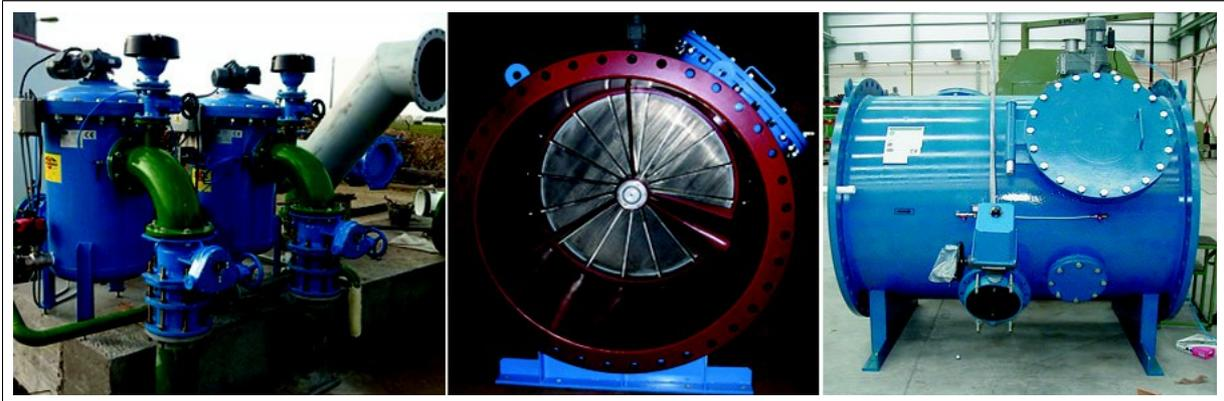
Ces dispositifs permettent de continuer à filtrer en même temps tout en effectuant un auto-nettoyage, ce qui est particulièrement approprié pour les applications dans lesquelles le filtrage en continu est un paramètre important du processus. Filtramas recommande l'installation de ses filtres en ligne FB ou FW en fonction des besoins de flux et de filtration.
